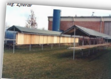
Billede 3. Panelemner eksponeret lodret mod syd under tag. Forår umiddelbart efter opsætning år 2000.
